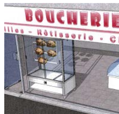
Un four, une rôtissoire, ou tout autre dispositif émettant une forte chaleur à proximité de la baie.
